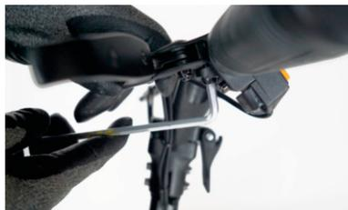
Podesite položaj ručice kočnice i pričvrstite šrafove za fiksiranje sa 5mm šestougaonim imbus ključem.
